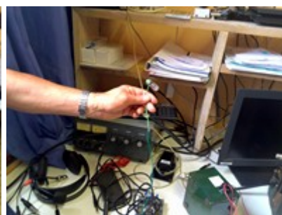
Neonlampje aan de antennezender tunen op max. licht
